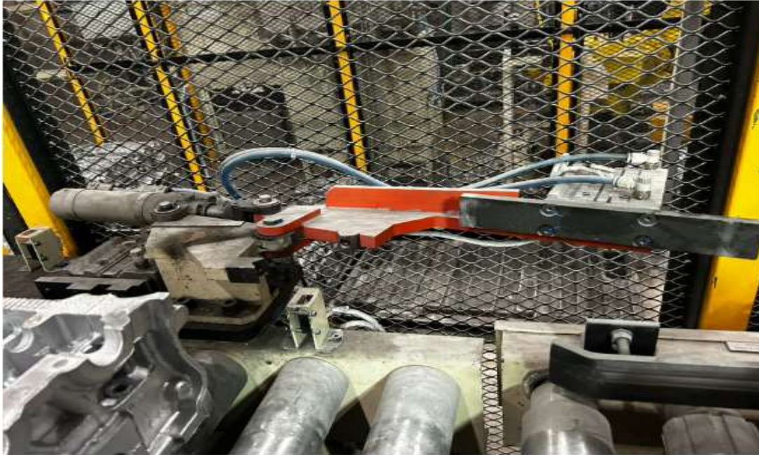
Ilustración 5.20: Centralizador de pieza. Fuente: Propia.
